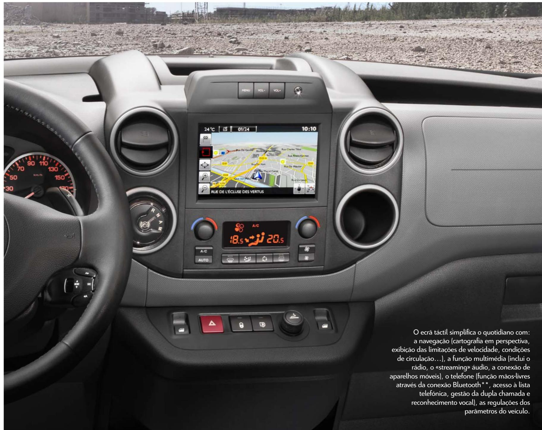
O ecrã táctil simplifica o quotidiano com: a navegação (cartografia em perspectiva, exibição das limitações de velocidade, condições de circulação...), a função multimédia (inclui o rádio, o «streaming» áudio, a conexão de aparelhos móveis), o telefone (função mãos-livres através da conexão Bluetooth\*\*, acesso à lista telefónica, gestão da dupla chamada e reconhecimento vocal), as regulações dos parâmetros do veículo.
