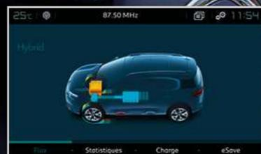
**Fluxo de energia:** permite visualizar o funcionamento da tecnologia híbrida.
